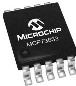
Obrázek 4.3: Obrázek obvodu dohledu baterie MCP73833, převzato z [21]
