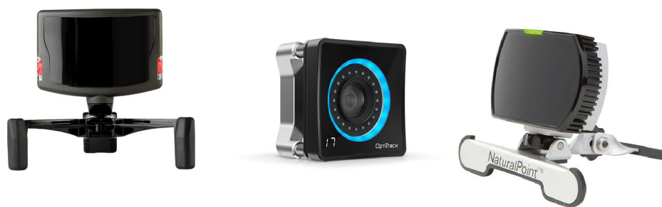
Obrázek 2.9: Obrázek technologií nabízených firmou NaturalPoint: zleva Trackir, OptiTrack a SmartNav, převzato z [28], [26] a [27]
