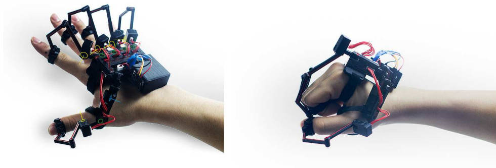
Obrázek 2.12: Obrázek exoskeletonu ke snímání pohybu prstů od firmy Dexta Robotics, převzato z [4] a [3]
