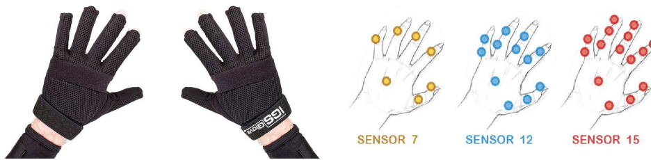
Obrázek 2.16: Obrázek rukavic s inerciálními snímači od firmy Synertial, převzato z [46]
