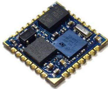
Obrázek 4.1: Obrázek skutečného modulu iNemo M1, převzato z [44]
