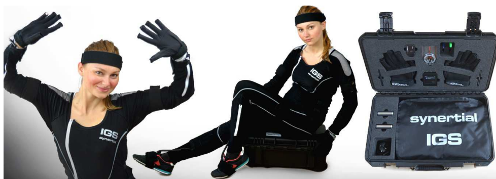
Obrázek 2.15: Obrázek obleku s inerciálními snímači od firmy Synertial, převzato z [48]
